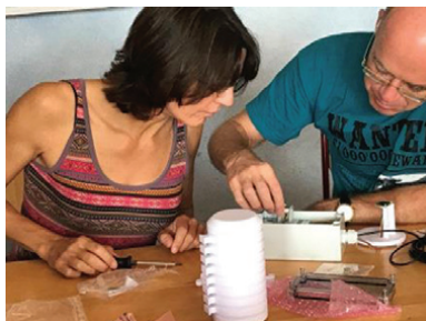
Sensoren zur Klimamessung werden gebaut. Foto: WILA Bonn
