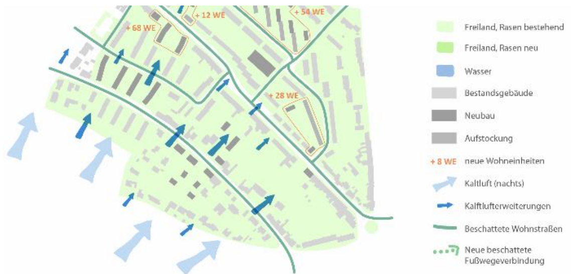
Abbildung 56: Gedrehte oder ersetzte Gebäude (in dunkelgrau) in einem Bestandswohngebiet unter Kaltlufteinfluss
